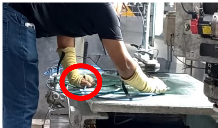
Figura 19: Operador del área de corte realizando el ajuste de posición desconectando solo una manguera neumática (López, 2023).
