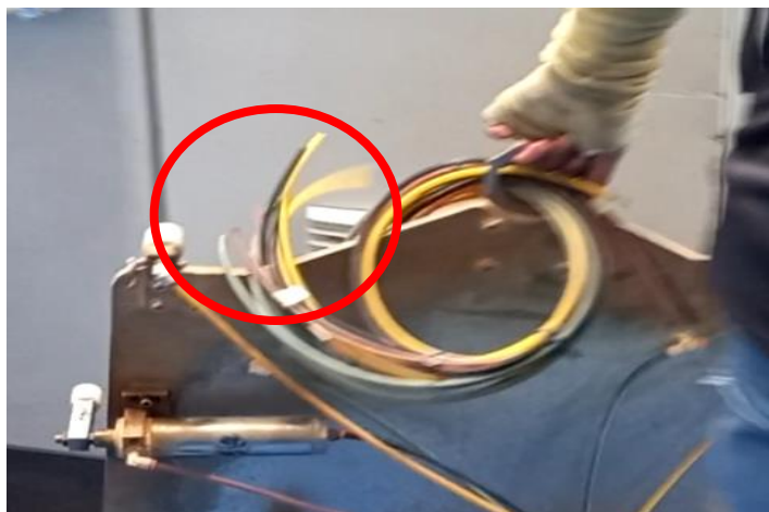
Figura 20: Muestra de mangueras dispersas en guía para taladro (López, 2023).
