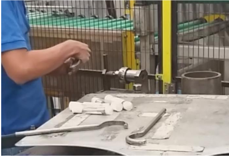
Figura 17: Operador del área de corte realizando el cambio de broca (López, 2023).
