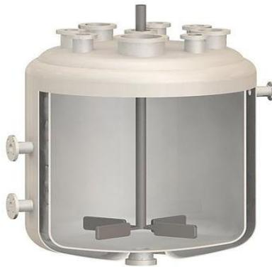
Figura 1.20 Diseño de un Biorreactor Batch, Gil & León (2021).
