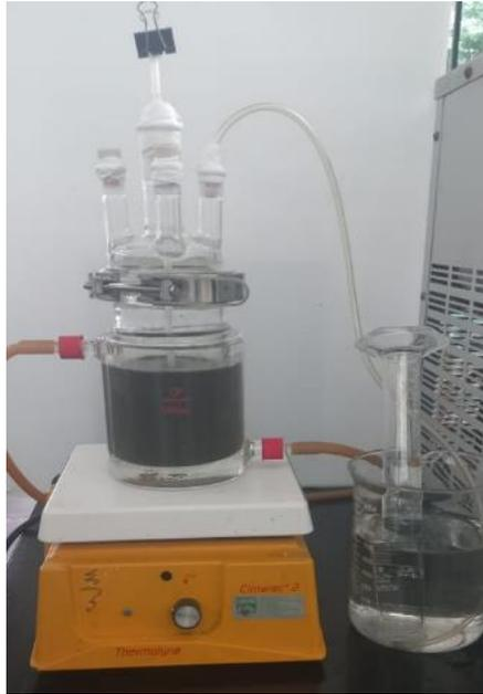
Figura 3.10 Reactor tipo batch para fermentación Acido láctica.
