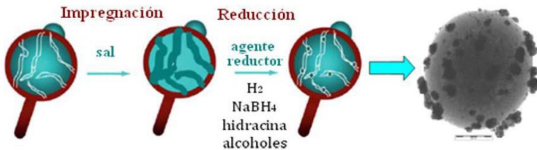
Figura 1.1 Representación esquemática de la preparación de nanopartículas soportadas por el método de deposición/reducción convencional (Pineda et al. , 2011).
