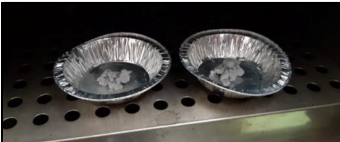
Figura 2.4 Secado en horno de \text{TiO}_2 modificado
