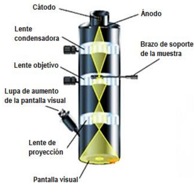
Figura 1.3 Esquema de un microscopio electrónico de transmisión (Faraldos y Goberna, 2002).
