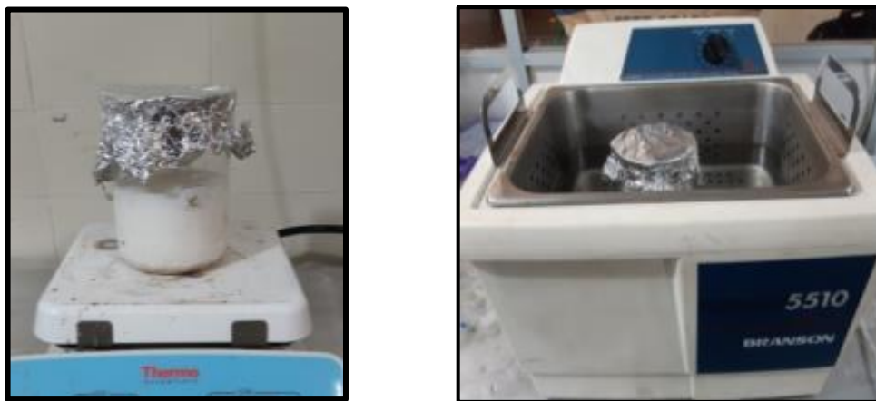
Figura 2.3 Incorporación de \text{TiO}_2 en Etanol (Proceso intercalado de agitación y sonicación).
