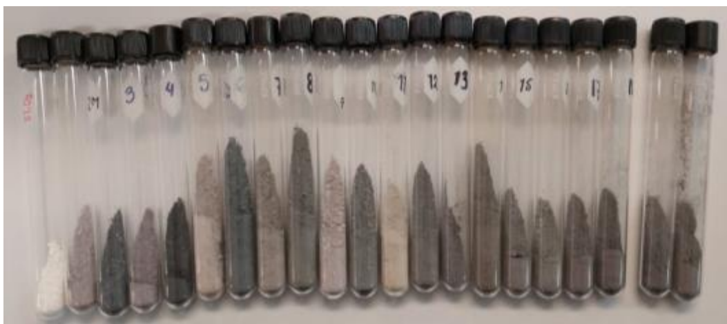
Figura 3.9 Unidades experimentales de la deposición de Ag en \text{TiO}_2 silanizado.
