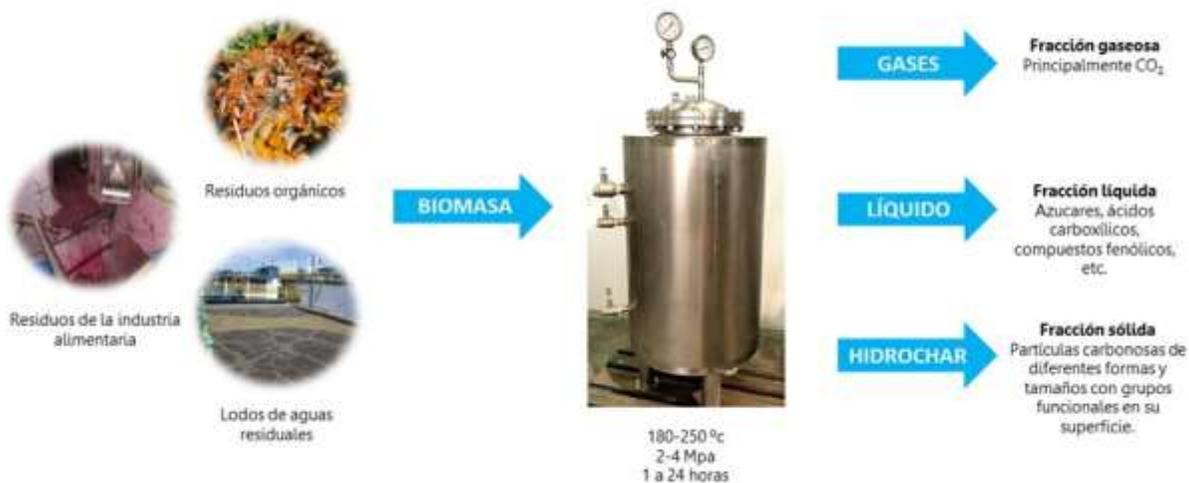
Figura 1.9 Esquema del proceso de carbonización hidrotermal de biomasa.
