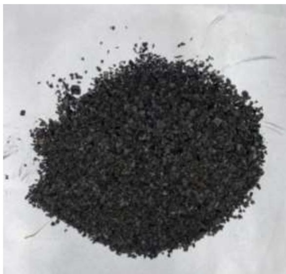
Figura 3.17. Biochar obtenido del proceso de pirólisis.
