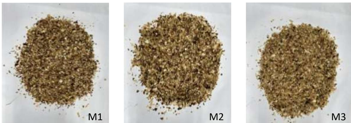
Figura 3.16 Mezclas de RSC acondicionadas para el proceso de pirólisis.
