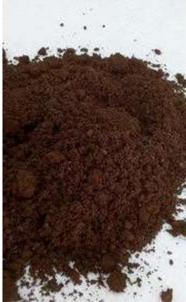
Figura 1.11 Hidrochar obtenido por carbonización hidrotermal.
