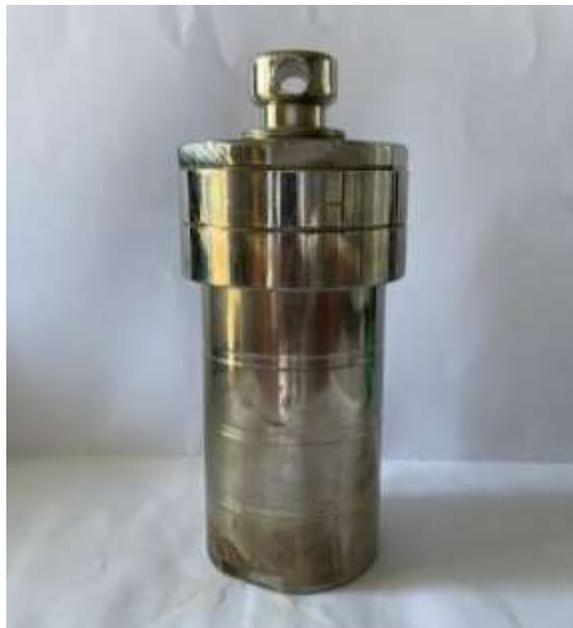
Figura 2.4 Reactor para carbonización hidrotermal.
