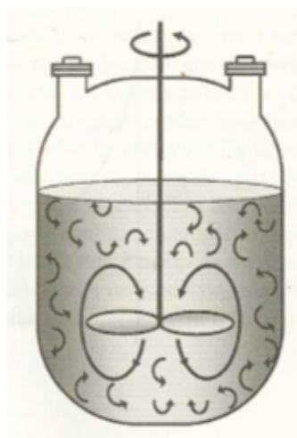
Figura 1.3. Esquema de un reactor intermitente (Fogler, 2008)
