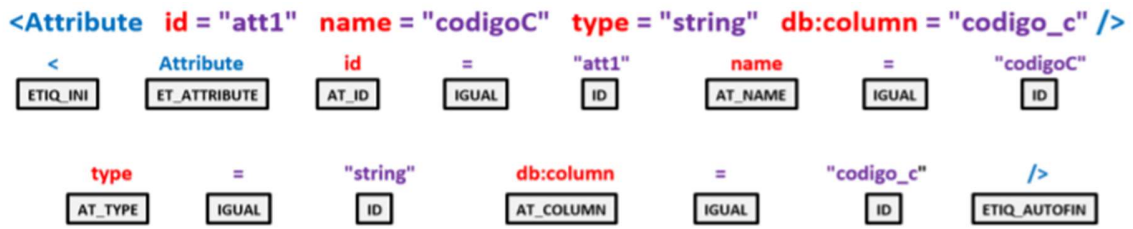
Figura 3.26 Ejemplo de la obtención de tokens de una etiqueta XML
