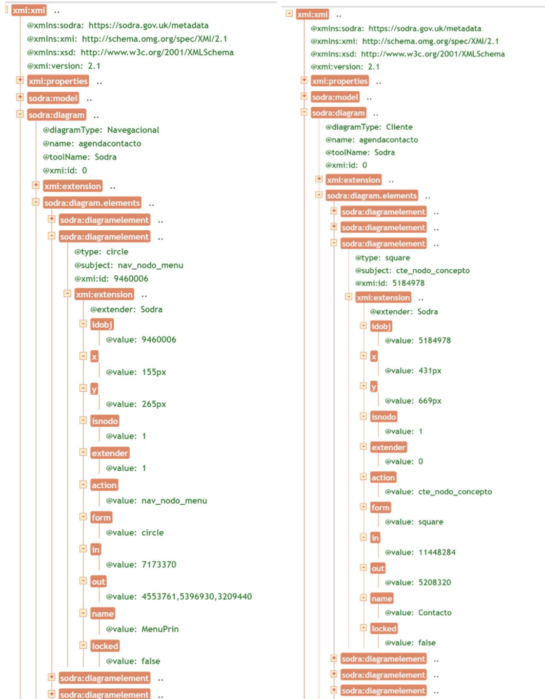
Figura 3.25 Estructura del nodo sodra:diagram del modelo XMI navegacional a la derecha y modelo XMI de cliente a la izquierda
