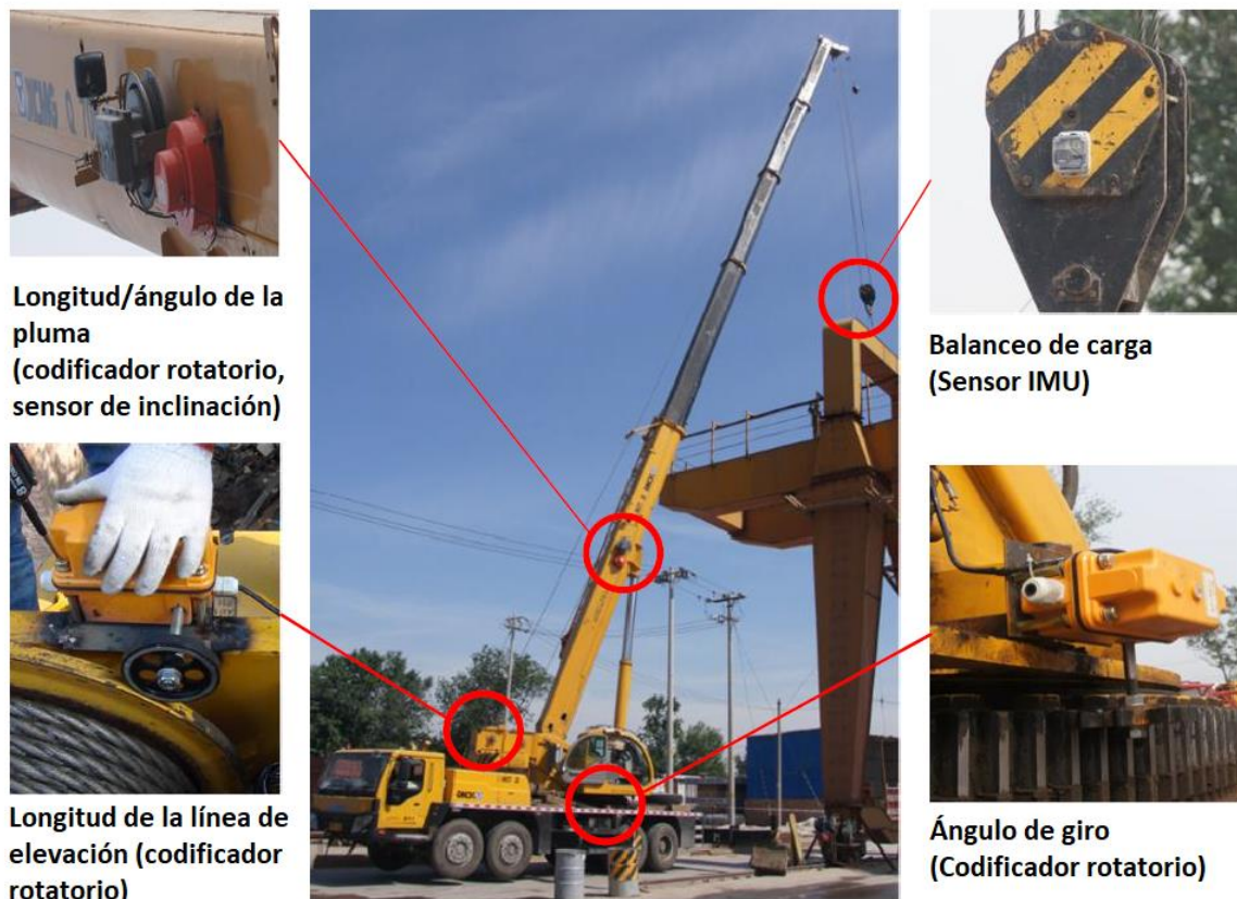
Figura 6 Configuración del sensor para captura de movimiento crítico, basado en [5].
