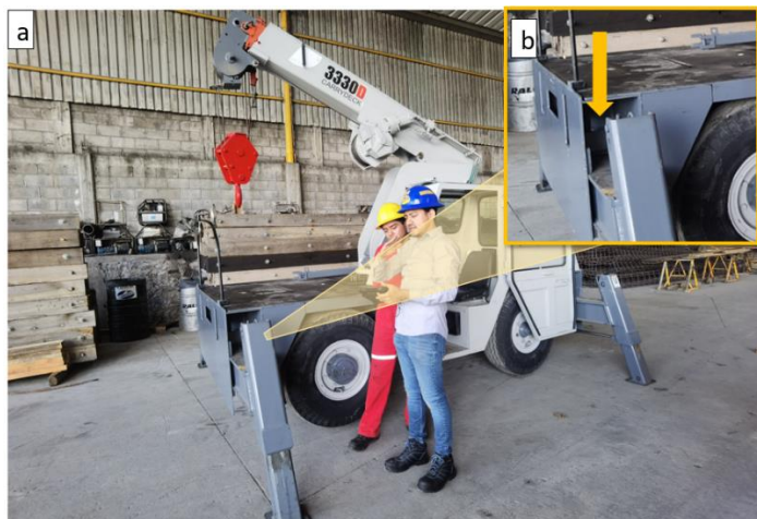
Figura 24 colocacion del sistema desarrollado. a) preparacion del operador, b) enfoque de la ubicación del sensor.
