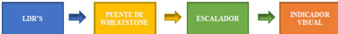
Figura 4 Diagrama a bloques del procesamiento de la señal del sensor de inclinación.
