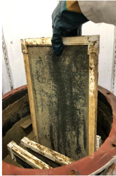
Figura 4.42 Soporte de fibras de Nylon Poliéster a. Limpio; b. Colonizado
