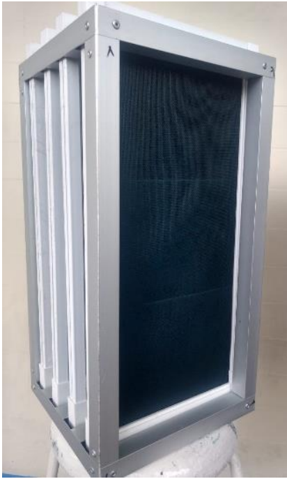
Figura 4.42 Soporte de fibras de Nylon Poliéster a. Limpio; b. Colonizado
