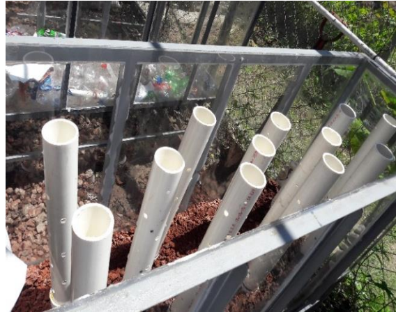
Figura 4.18 Tubos de extracción de muestra
