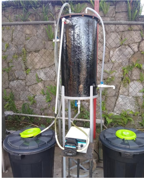
Figura 4.16 Reactor de Biopelícula Anaerobia pilot-scale montado
