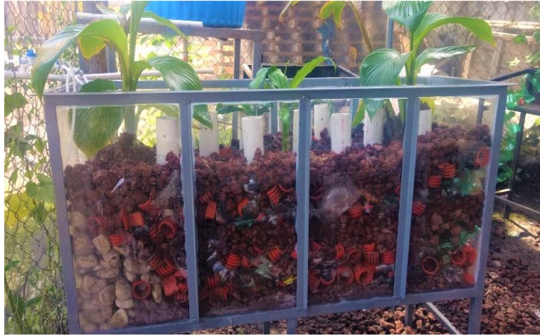
Figura 4.21 Celda con material de soporte.
