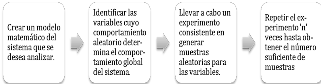
Figura 7. Metodología del método Monte Carlo. Fuente: (Librería nacional de estados unidos de américa, 2018).
