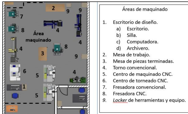
Figura 3. 5 Distribución del mobiliario y máquinas en el área de maquinado (Elaboración propia).
