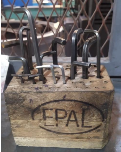
Figura 3. 18 Dispositivo Poka-Yoke para acomodo de llaves.
