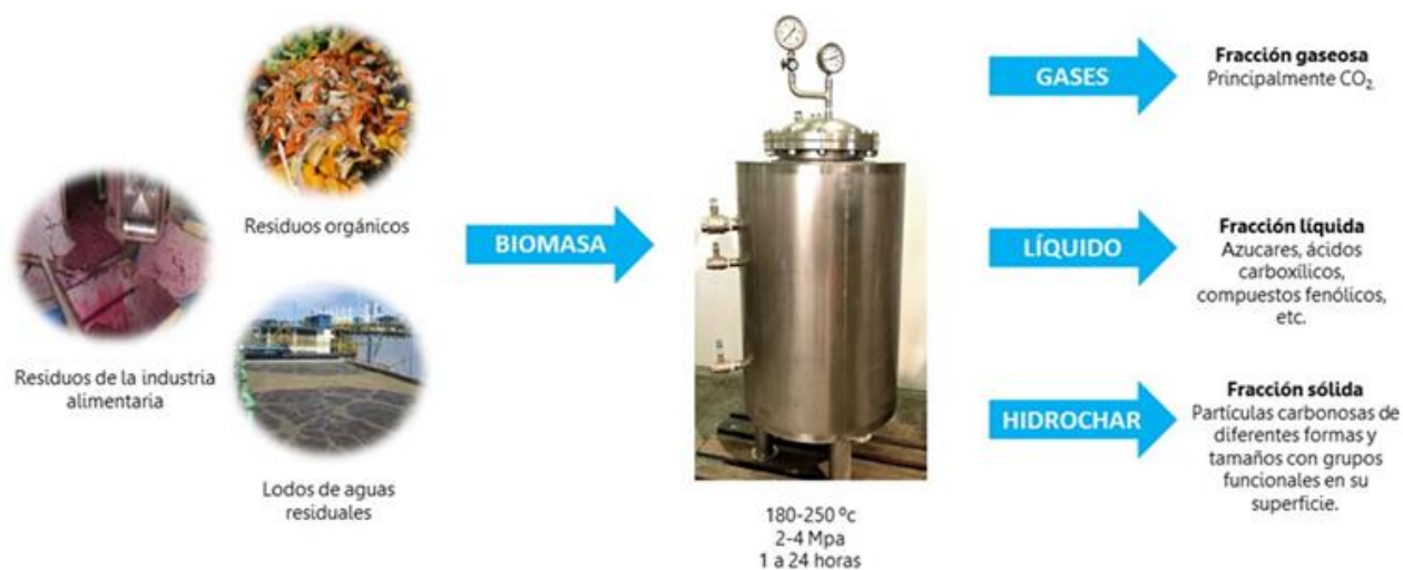
Figura 1. Esquema del proceso de carbonización hidrotérmica de biomasa.
