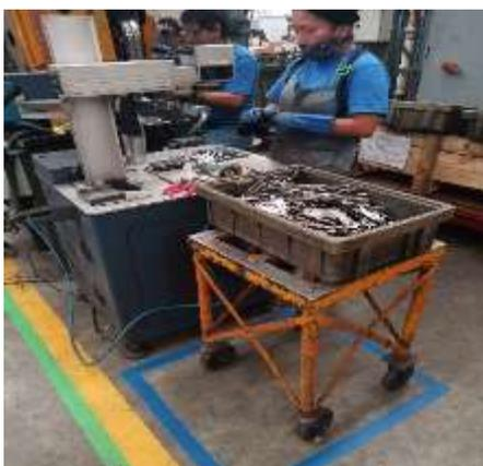
Figura 3. 60 Delimitación del área para material de entrada para clip/pin.
