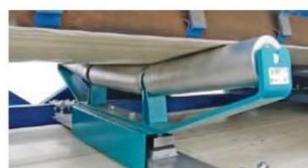
Pesaje continuo con regulación automática para la industria medioambiente
