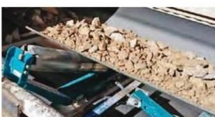
Pesaje continuo para la industrial minera y extracción de arenas / áridos.
