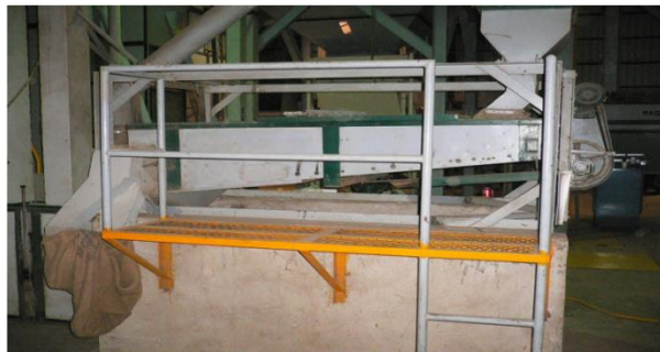
Figura 1.4 Máquina para realizar prelimpia del grano
