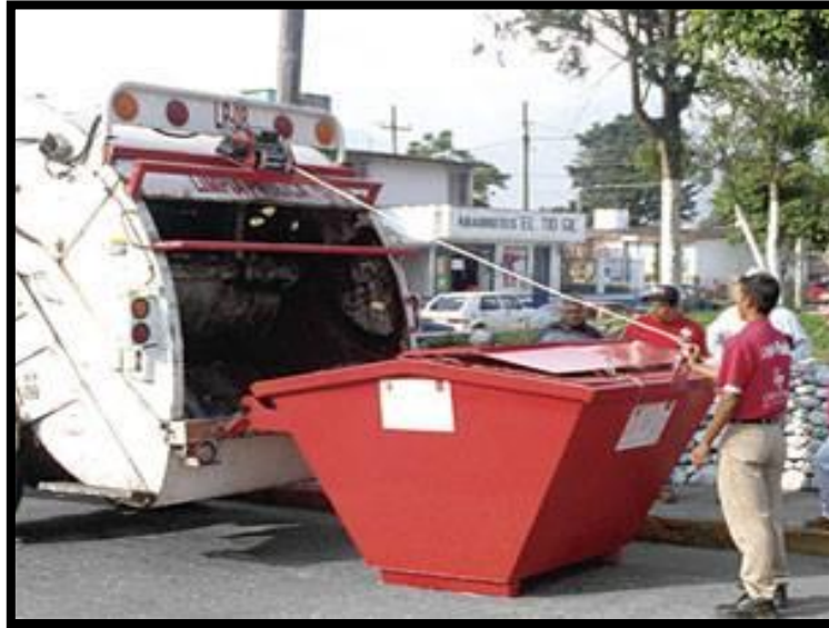
Figura 4.2. Uso de Winch para vaciado de contenedor
