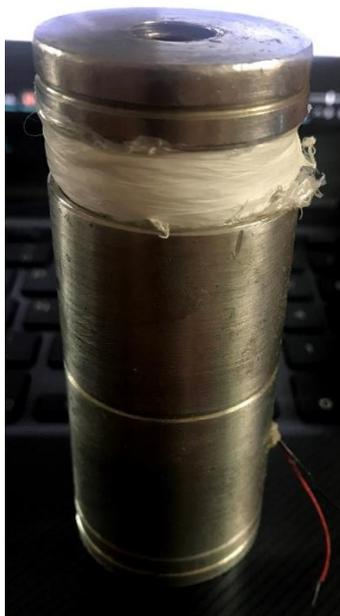
*Figura 30 Cilindro de pruebas tipo pistón sellado herméticamente.*
