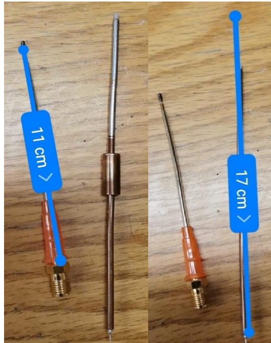
Figura 25 Antenas de 11 cm y 17 cm consideradas para la adaptación del sistema estereotáctico de posicionamiento a sus medidas finales.
