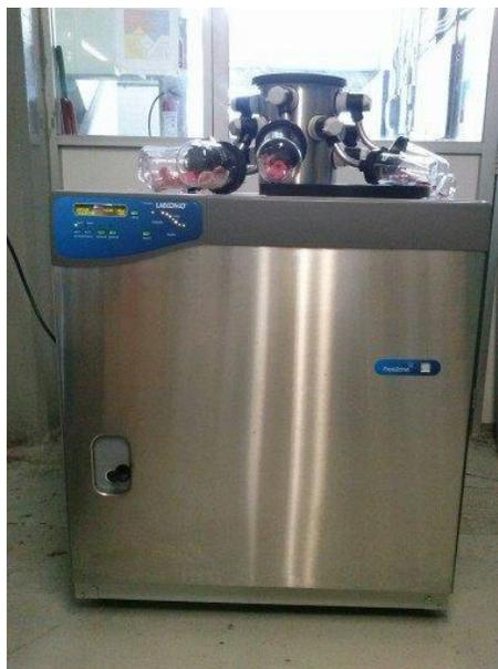
**Figura 2.6** Liofilizador LABCONCO Mod-742004.
