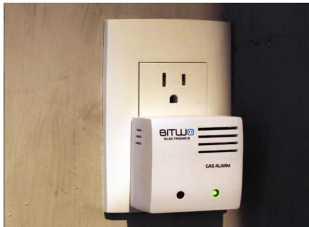
Figura 5.4 Detector de hidrógeno de la marca BITWO®.
