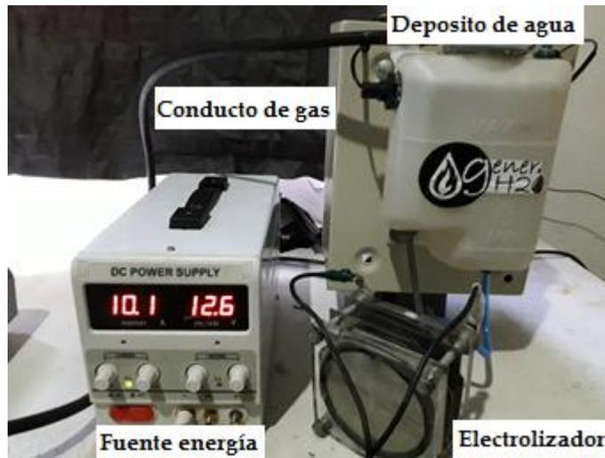
Figura 5.5 Sistema portátil generador de gas GENERH2.
