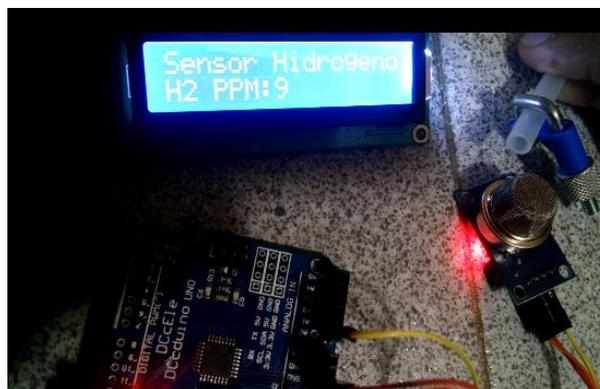
Figura 3.16. Sistema de detección en funcionamiento.
