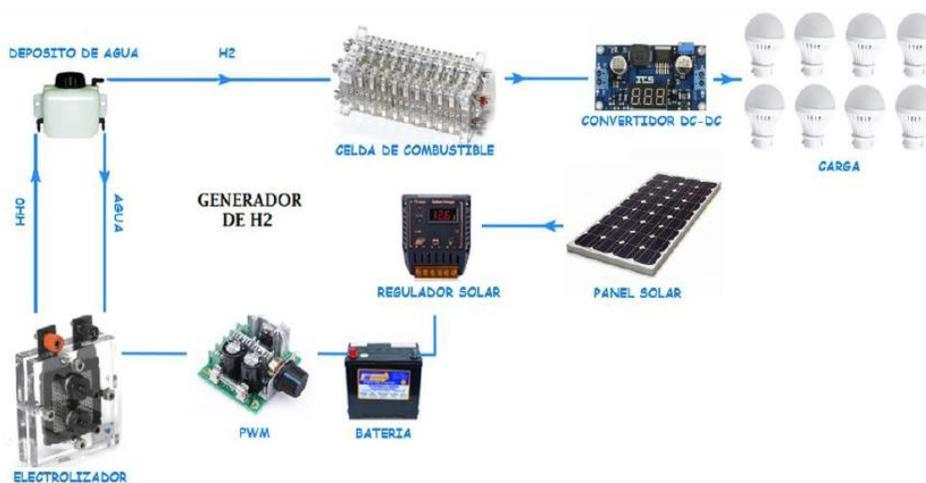
Figura 5.8 Sistema GENERH2 con energía solar.
