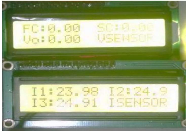
Figura 5.27 Lecturas de las señales del medidor de corriente y voltaje.
