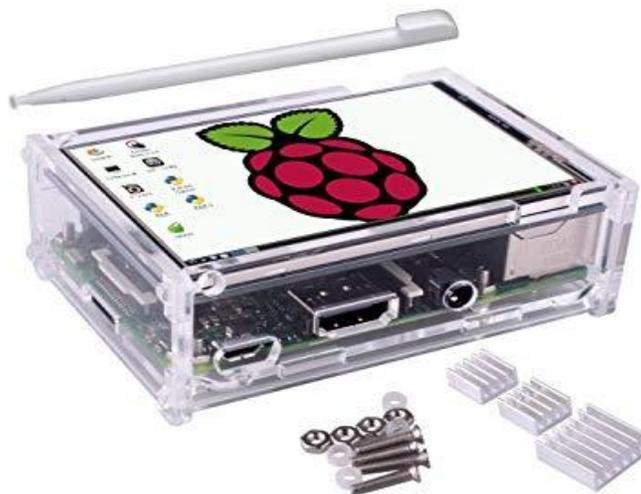
Figura 5.38 Pantalla *touchscreen* con Raspberry pi 3B.
