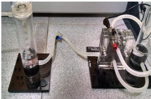
Figura 3.17. Electrolizador utilizado para la generación de hidrogeno.
