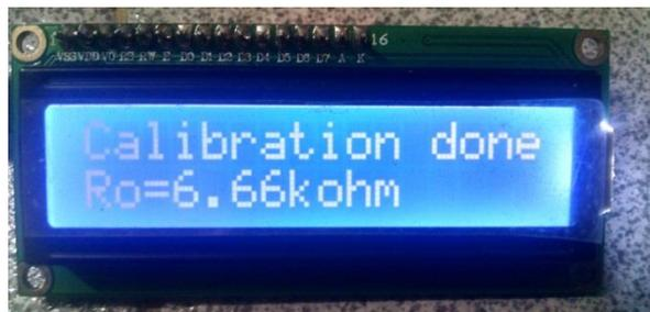
Figura 3.15. Calibración terminada (asignación resistiva).
