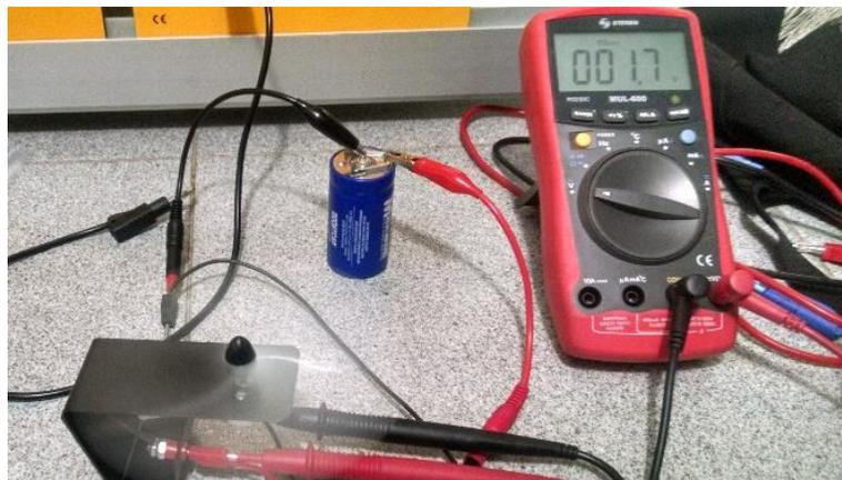
Figura 5.12 Pruebas de carga y descarga del supercapacitor Maxwell.
