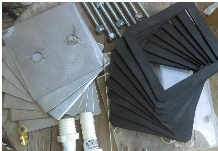
Figura 5.6 Construcción y armado del electrolizador.
