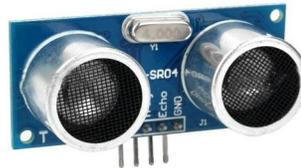
Figura 3.30: Sensor de distancia ultrasónico
