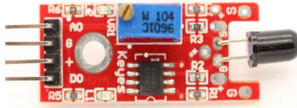
Figura 3.25: Sensor detector de flama
