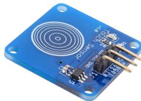
Figura 3.33: Sensor táctil capacitivo
