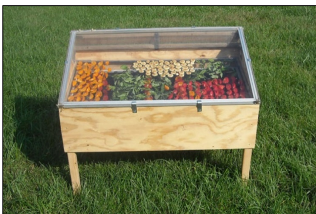
Figura 5.5 Deshidratador solar como propuesta de solución a la problemática registrada en los niveles de producción dentro del invernadero
