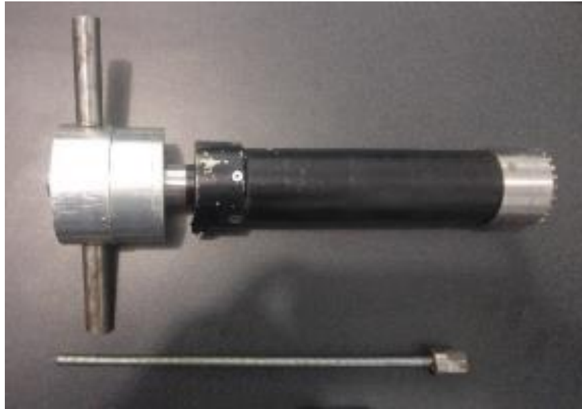
Figura 9. Mecanismo de extracción de suelo.
