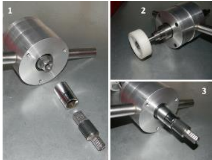
Figura 14. Sistema de expulsión. (1) componentes de la pieza hexagonal del acoplamiento (2 y 3): sistema de acoplamiento con tapón de nylamid y sin el respectivamente.
