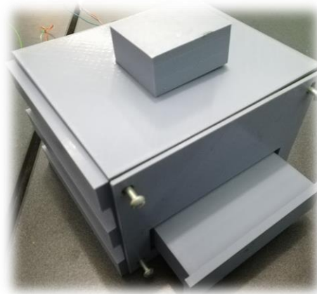
Figura 22. Componentes armados de la cámara de temperatura controlada.
