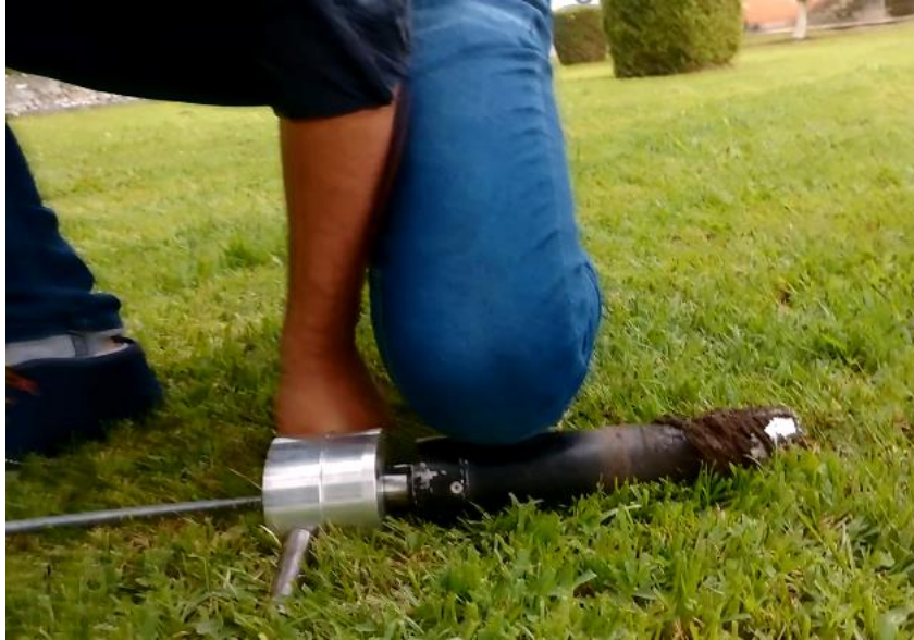
Figura 16. Integración del Sistema de expulsión con taladro
