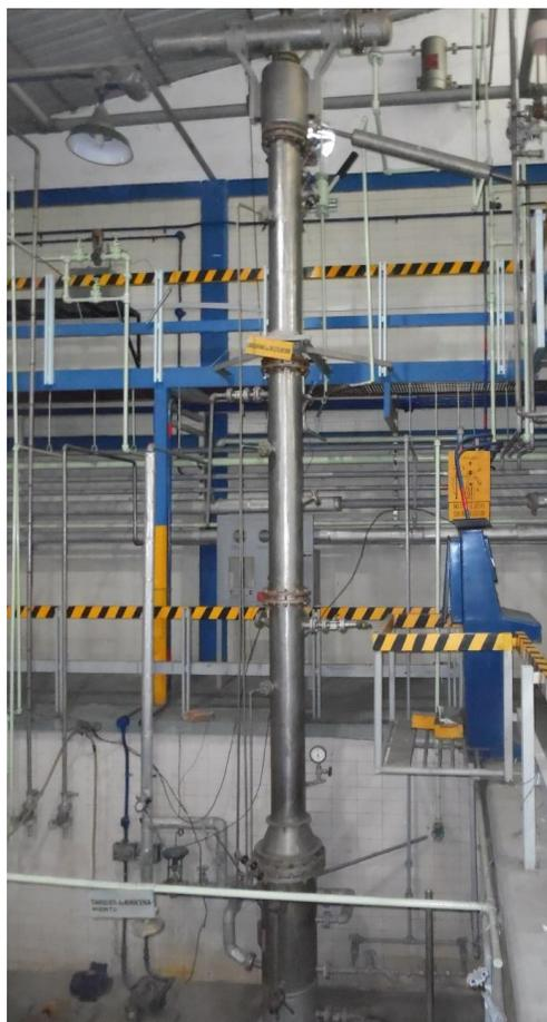
**Figura 3.48** Columna de destilación.
