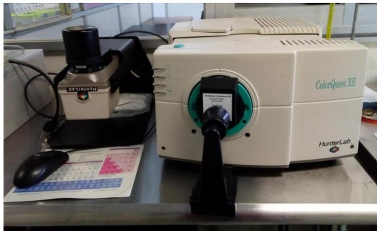
Figura 2.5 Colorímetro HunterLab.
