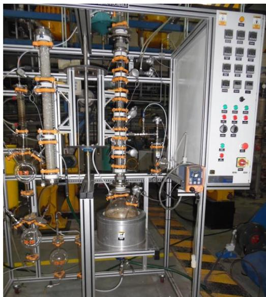
**Figura 3.46** Columna intercambiable.
