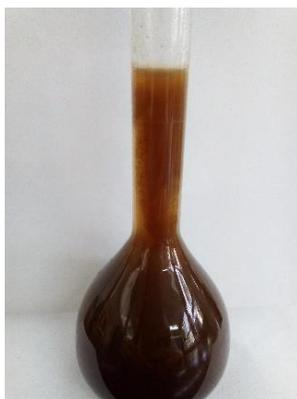
**Figura 3.22** Muestra de incrustación después del pretratamiento y dilución.
