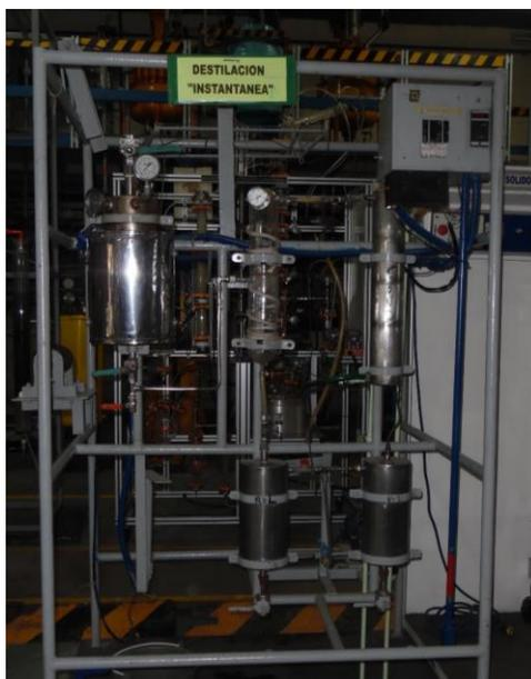
**Figura 3.47** Columna de destilación instantánea.
