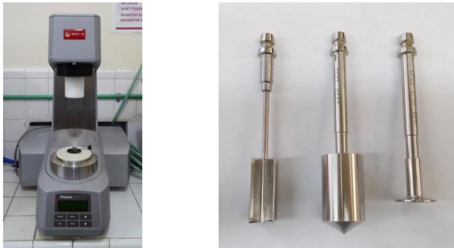
**Figura 2.2** Reómetro y geometrías utilizadas.
