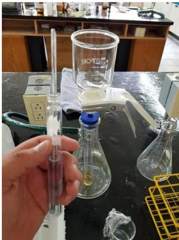
**Figura 3.23** Kit de filtración a vacío Millipore utilizado en las muestras.
