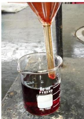
**Figura 3.21** Filtrado previo de la muestra de mosto fermentado.
