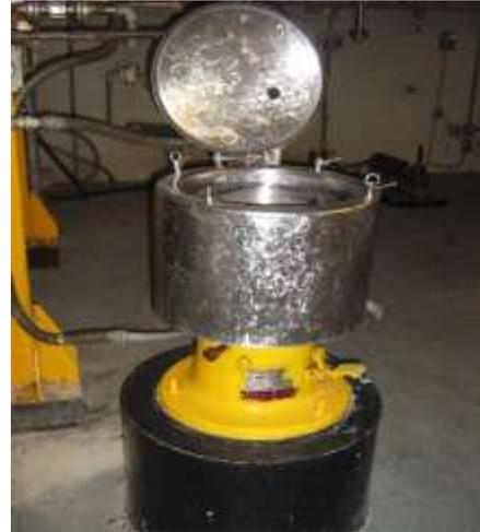
Ilustración 2-4 Filtración por medio de centrifuga
