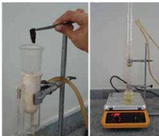
**Figura 2.8** Sistema de extracción Soxhlet
