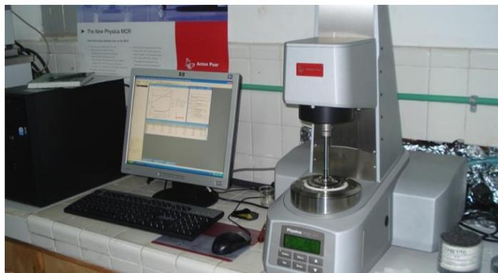
**Figura 2.10** Reómetro Anton Paar
