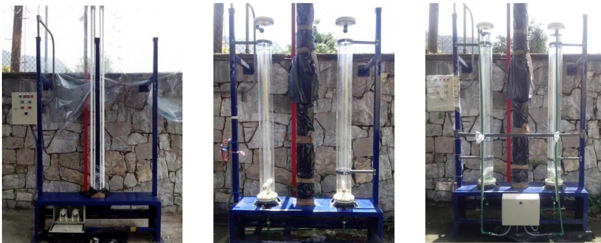
**Figura 3.25** Montaje de la sección de fotobiorreactores nivel planta piloto
