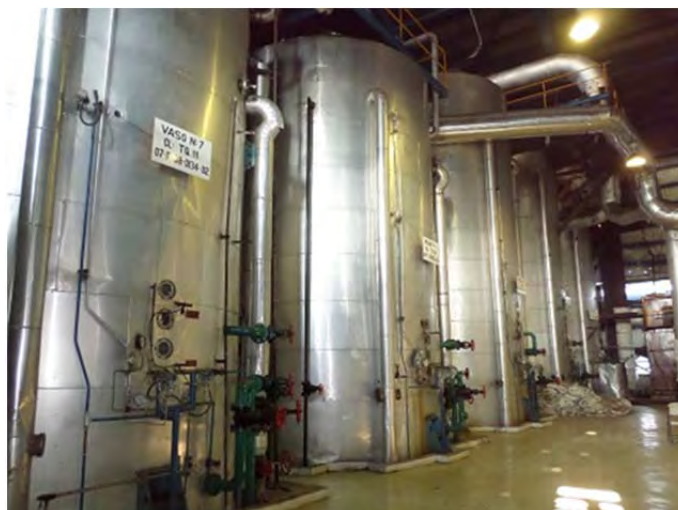
Imagen 37. Evaporación de azúcar (Vasos evaporadores)
