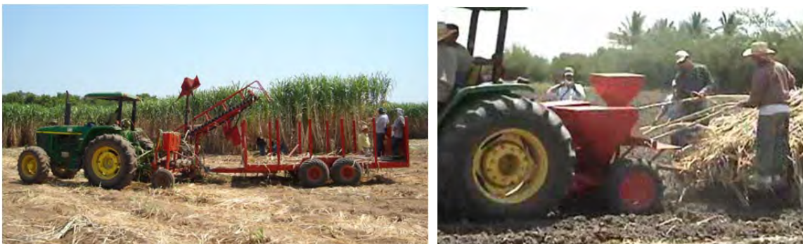
Imagen 16. Cosechadora de semilla de caña y sembradora mecánica de semilla de caña
