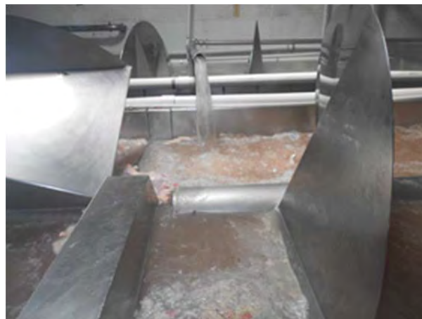
Imagen 12. Enfriamiento y desinfección de pollo procesado en chiller's
