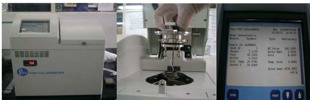
Imagen 43. Calorímetro automático, colocación de la muestra, y display del resultado
