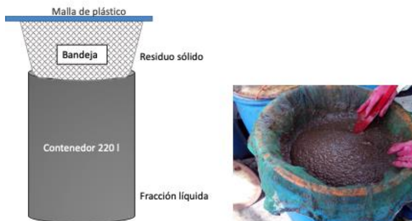
Figura 3.11 Filtración manual del RSO
