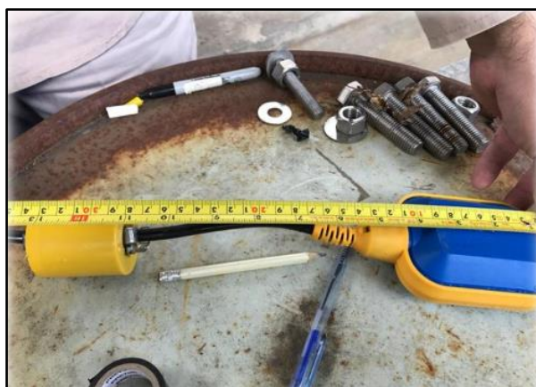
Figura 3.19 Flotador eléctrico utilizado para la operación de la bomba de recirculación
