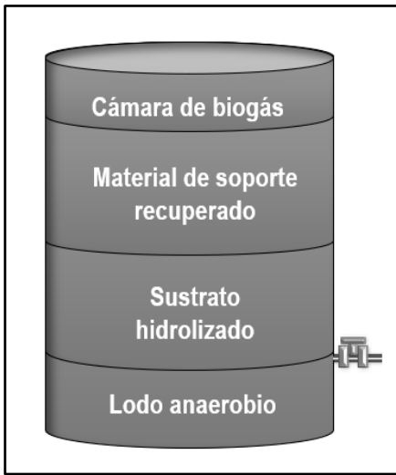
Figura 2.5 Tanque de recuperación de material de soporte
