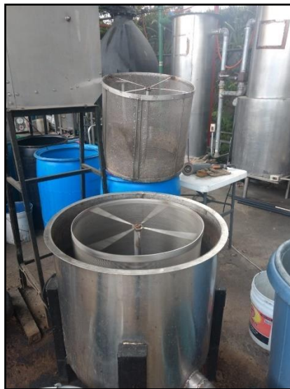
Figura 3.13 Rediseño de centrifugadora industrial
