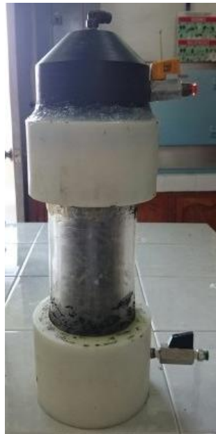
Figura 3.1 Reactor Anaerobio Híbrido (a) lecho fijo y (b) lecho fluidizado inverso.
