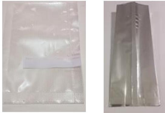
**Figura 2.20** Empaque de polietileno y metalizado
