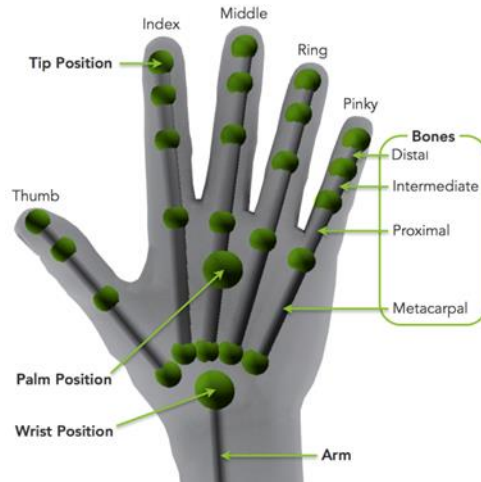
Figura 3.3 Segmentos de la mano identificados por el dispositivo Leap Motion [23]. El dispositivo provee los datos de rastreo mediante un sistema de coordenadas en tres dimensiones (Figura 3.4) o alternativamente con imágenes (sin procesar) de cada una de las cámaras. La Figura 3.5 muestra un ejemplo del dispositivo en funcionamiento.
