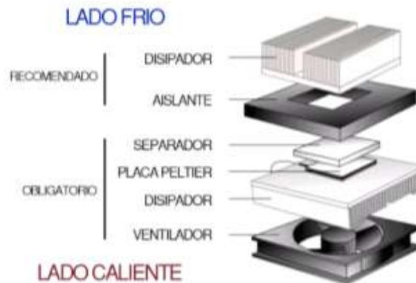
Figura 2.5: Arreglo: celda Peltier, disipadores y ventilador. Fuente: Llamas (2016).
