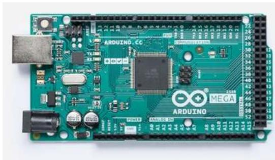
Figura 2.10. Arduino Mega. Fuente: Arduino (2014)
