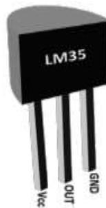
Figura 2.11: Sensor de temperatura LM35. Fuente: Lechuga, Figueroa, & More (2011).
