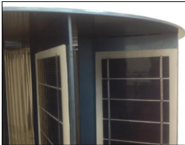
Figura 4 Serie de paneles fotovoltaicos en el generador solar-eólico híbrido.
