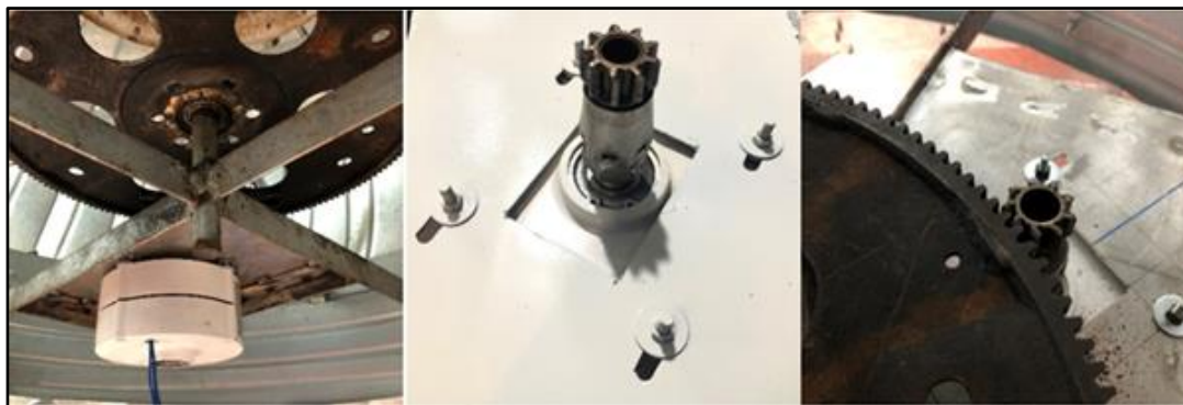
Figura 42: Sistema de transmisión del generador eléctrico NE-200M2.
