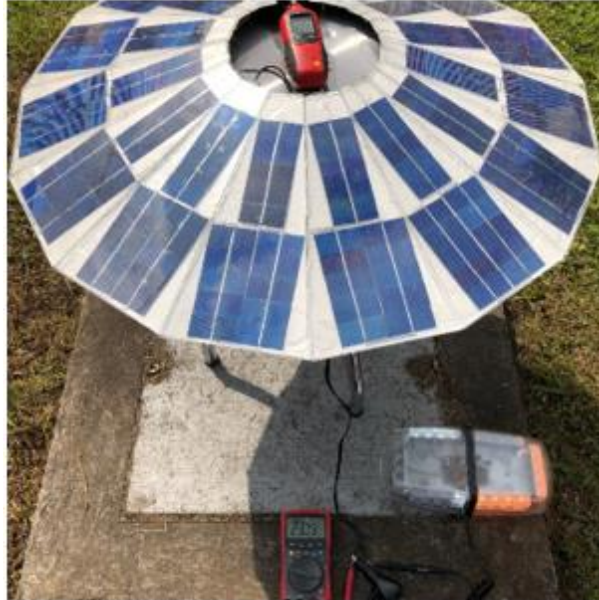
Figura 39 Salida del generador.
