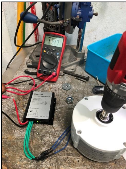
Figura 34 Prueba al generador eléctrico NE-200M2
