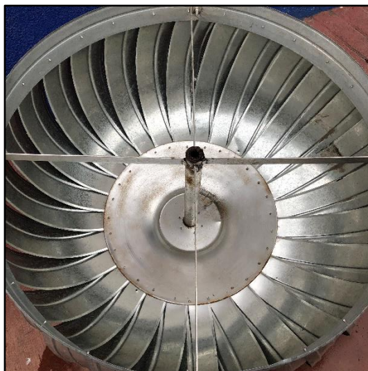
Figura 29 Vista inferior del Aerogenerador y eje motriz
