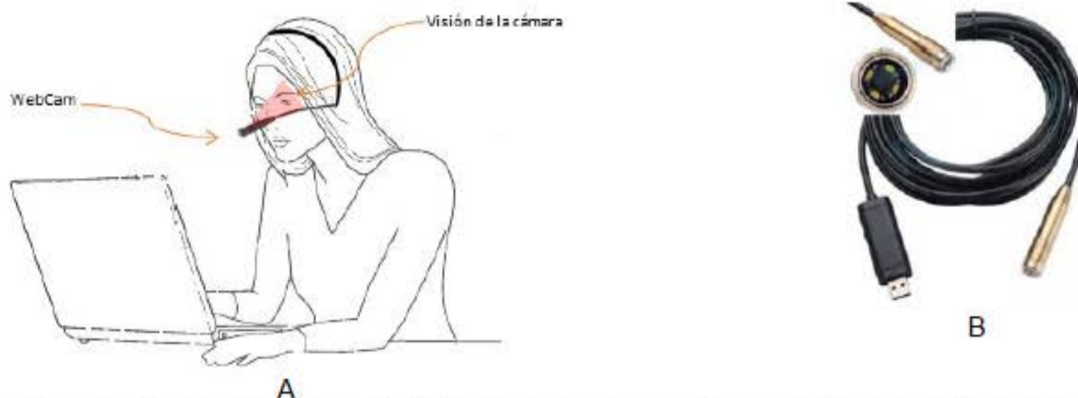
Figura 2. A. Se observa la colocación de la cámara en el usuario, montada cerca del ojo del usuario. B. Cámara utilizada en este algoritmo.
