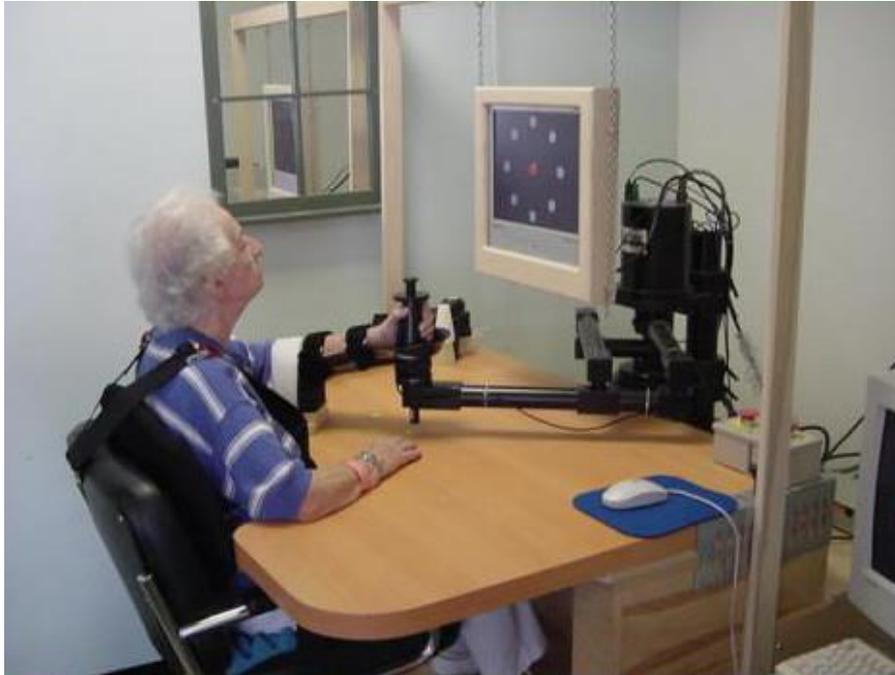
Figura 16 Versión comercial Robot-Planar MIT-MANUS en terapia dentro del hospital de rehabilitación de Burke(White Plains,NY) [15].
