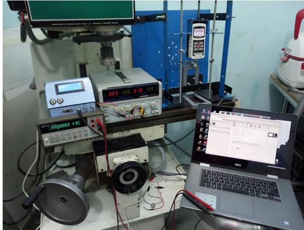
Figura 59 Modulo de calibración con módulo de tensión.
