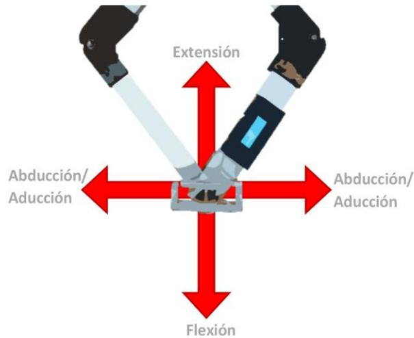
Figura 1069 Fuerzas generadas sobre el joystick.
