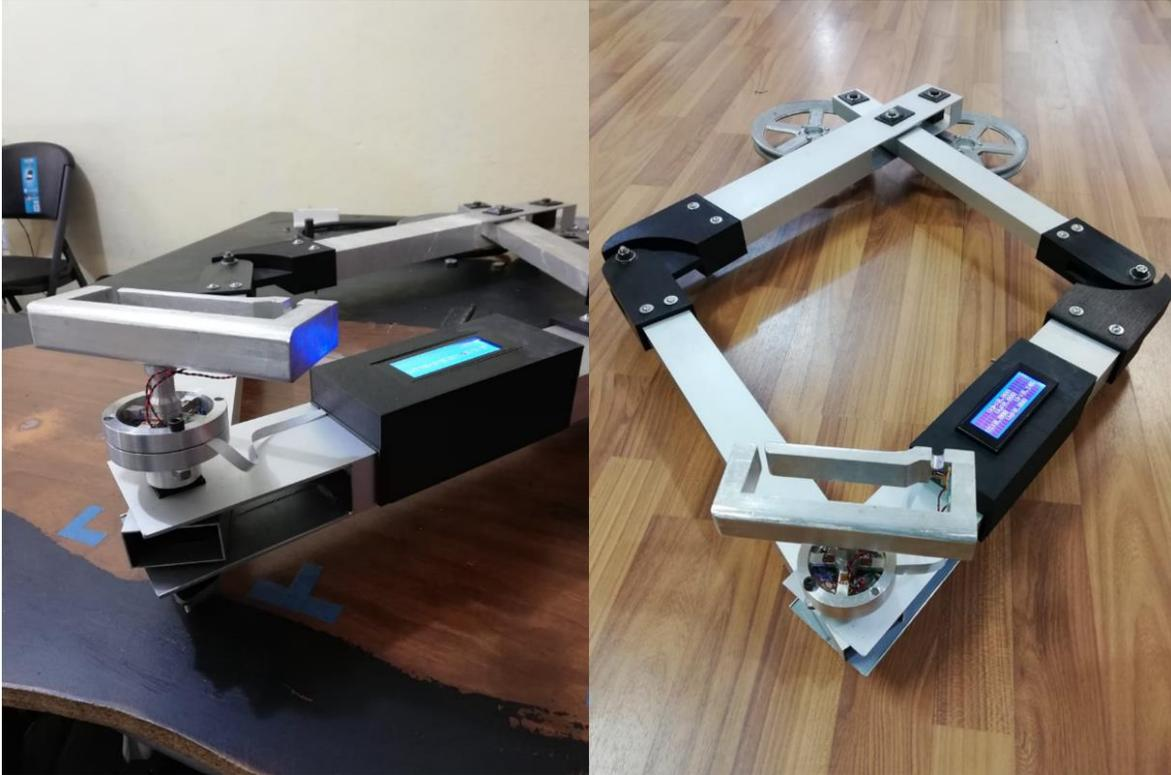
Figura 1058 Joystick integrado al robot planar.
