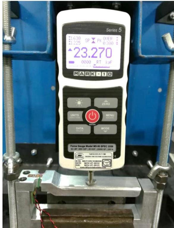
Figura 97 Aplicación de fuerza por medio de prensa mecánica en el sensor de fuerza dígito palmar.
