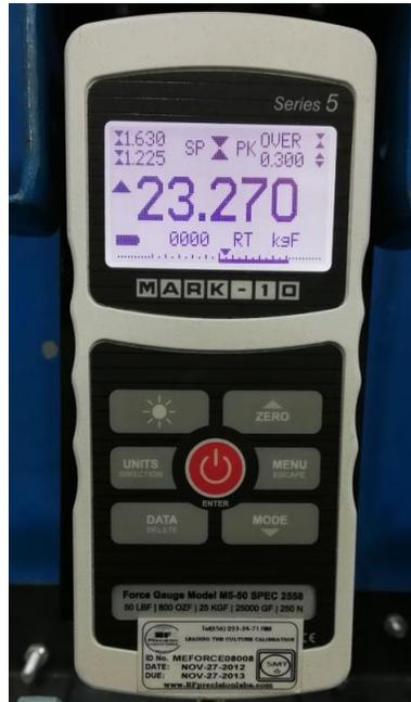
Figura 947 Dinamómetro Mark-10 Series 5 Modelo M5-50.
