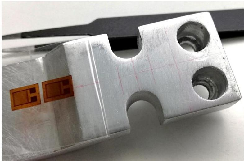
Figura 89 Ubicación de la zona de adhesión de galga extensiométrica.
