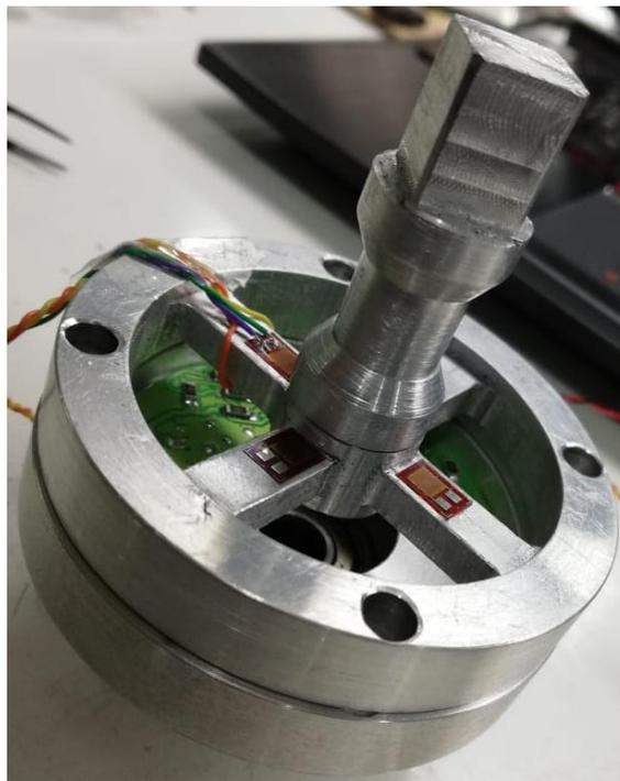
Figura 77 Sensor de fuerza aplicada armado.
