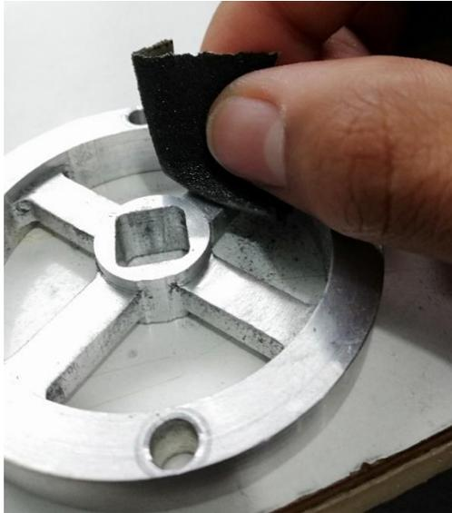
Figura 91 Lijado de sensor de fuerza aplicada.
