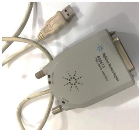
Figura 1025 Cable de datos USB/GPIB Agilent Technologies 82357A.
