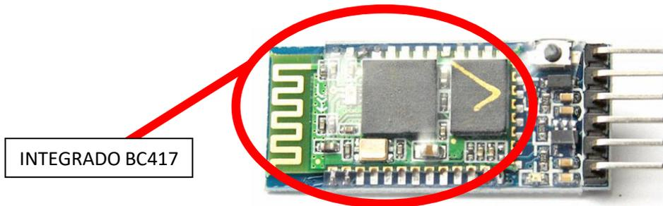
Figura 46 Módulo HC-05 de comunicación bluetooth usado.
