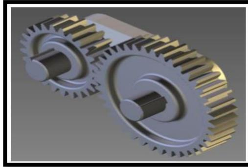
Figura 8 Engranaje cilíndrico, dentado recto
