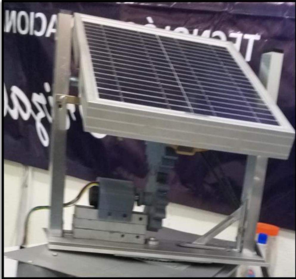
*Figura 41 Estructura final del prototipo panel elevado*
