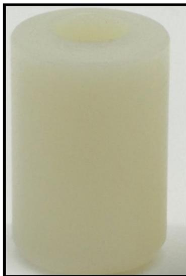
Figura 23 Tubo o barra redonda de nylamid
