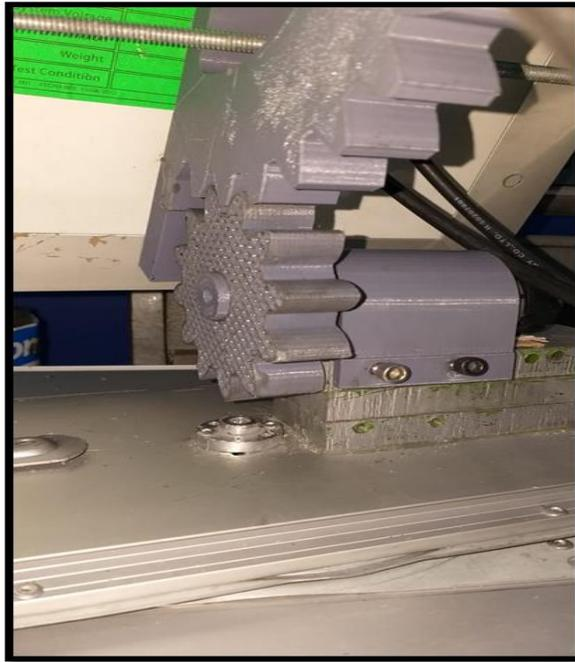
*Figura 31 Arreglo de trasmisión (final)*
