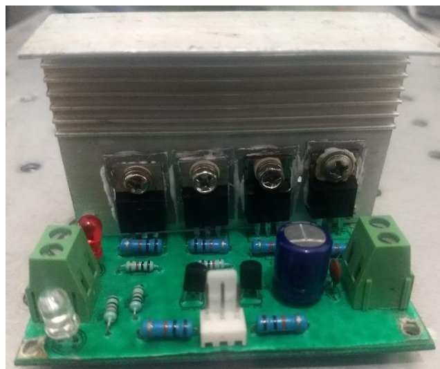
Figura 32. Manufactura del PCB puente H.
