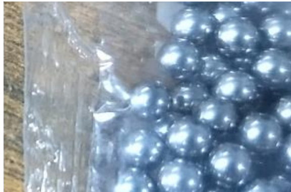
Figura 62. Material de construcción del Sensor Hot-Ball (Balines de acero)
