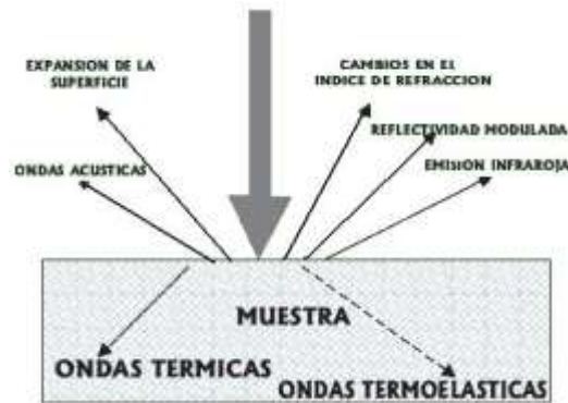
Figura 2. Efectos físicos del fenómeno fototérmico.
