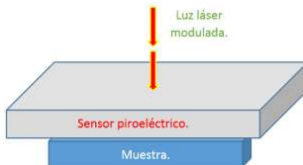
Figura 6. Configuración inversa en la técnica fotopiroeléctrica.
