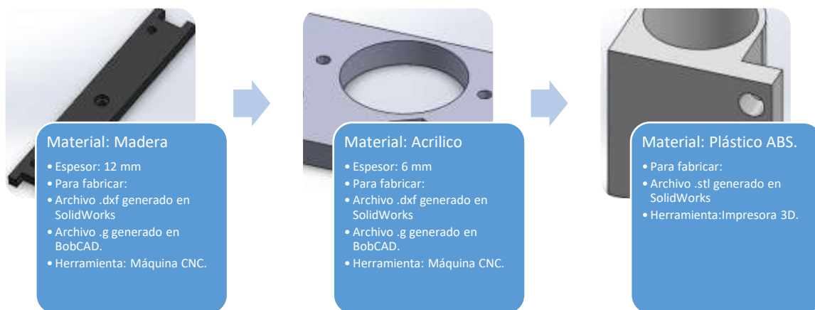
Figura 30. Diagrama a bloques para la fabricación de los elementos del sistema.
