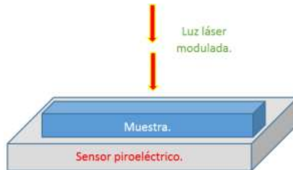
Figura 5. Configuración directa en la técnica fotopiroeléctrica.
