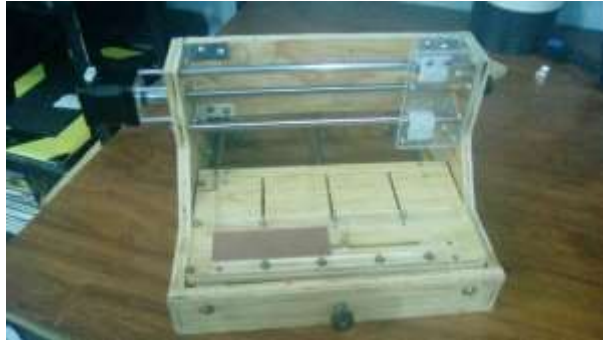
Figura 33. Armado de los ejes X-Y previo a la manufactura del eje Z.
