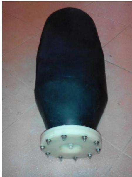
*Ilustración 7. Pulmón diseñado para la captación de biogás.*
