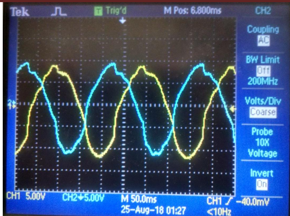
Figura. 62 Prueba de las señales a 5 Hz de frecuencia, 100% amplitud programada. Medida tomada antes de pasar por el transformador y únicamente de dos fases.
