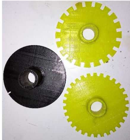
Figura 32 Encoder para medición de velocidad.
