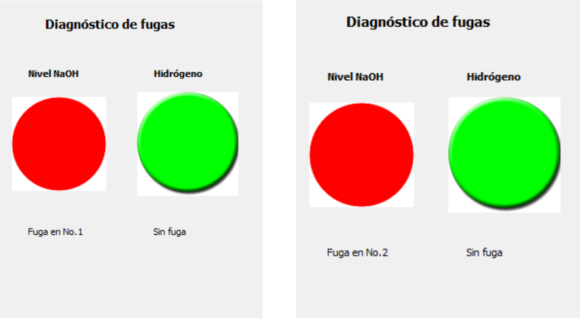
Figura 58 Detección de fugas NaOH
