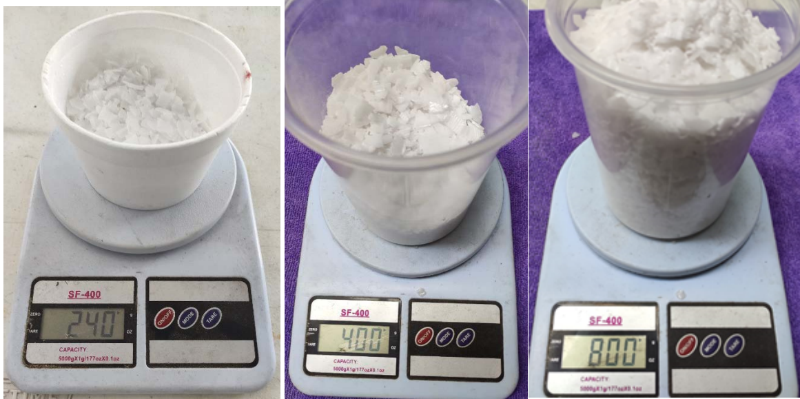
Figura 73. Peso equivalente según Porcentaje de la sosa caustica. a)3% b)5% c)10%.
