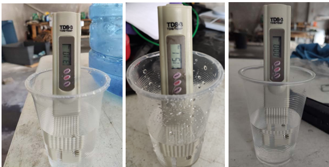
a) b) c) Figura 72. Conductividad en agua a) agua superficial b) agua de la llave c) agua destilada
