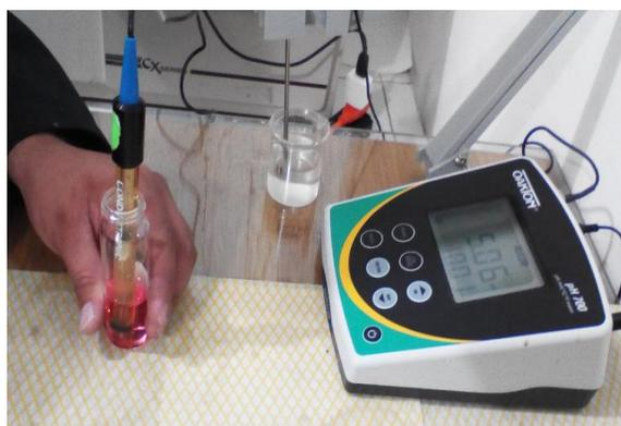
Figura 2.2 Calibración con tampón pH 4.
