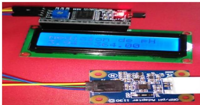
Figura 2.28 Conexión de la pantalla LCD 4X16.
