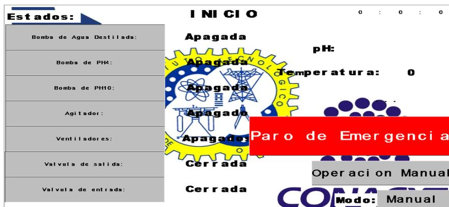
Figura 4.20 HMI del sistema automatizado de medición de pH.
