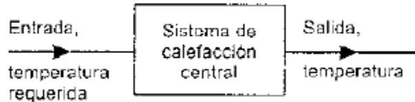
Figura 1.25 Sistema de calefacción central [14].
