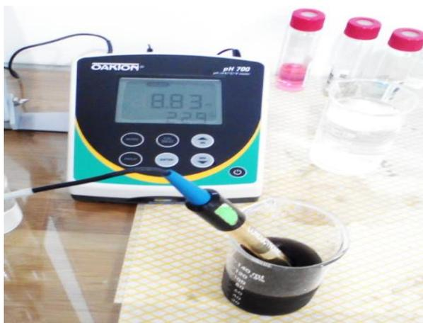
Figura 2.5 Medición de pH de una muestra del reactor.
