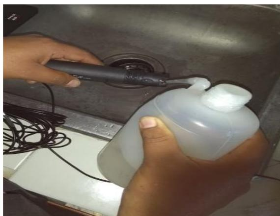
Figura 2.3 Limpieza del sensor de pH con agua destilada.
