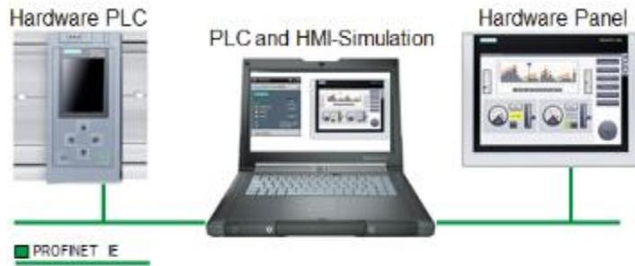
Figura 1.23 Hardware de comunicación PLC, PC y HMI [13].
