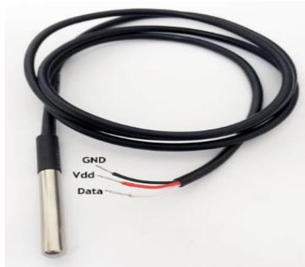
Figura 2.24 Sensor de temperatura DS18B20 [11].
