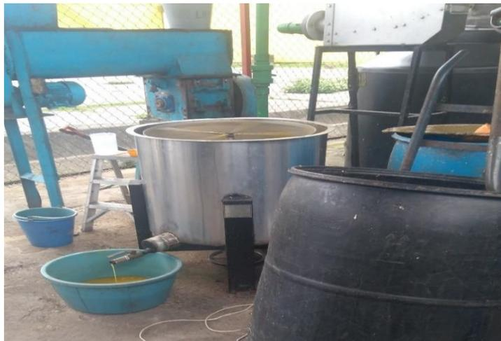
Figura 1.41 Molienda de materia prima para la etapa de Hidrólisis.
