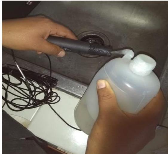
Figura 2.21 Limpieza del sensor de pH con agua destilada.
