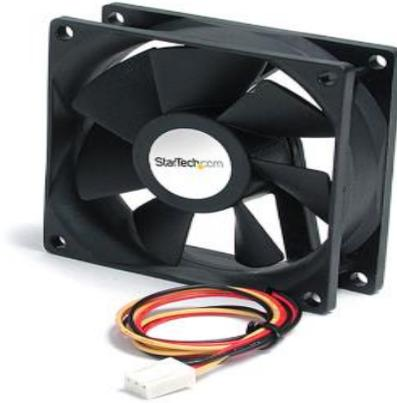
Figura 1.15 Ventilador para computadora.
