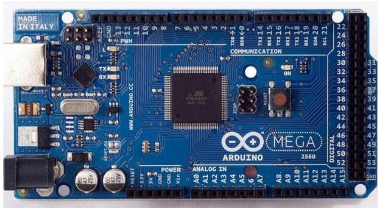
Figura 1.8 Microcontrolador Arduino ATmega2560 [10].
