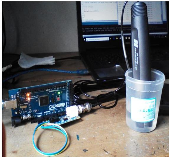
Figura 2.17 Medición de la solución tampón 6.86.
