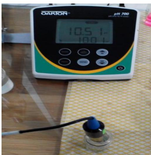
Figura 2.4 Electrodo en pH 4.00.
