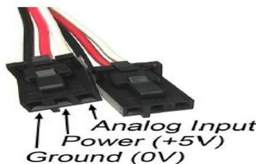
Figura 2.13 Cable Molex para el Adapter 1130.
