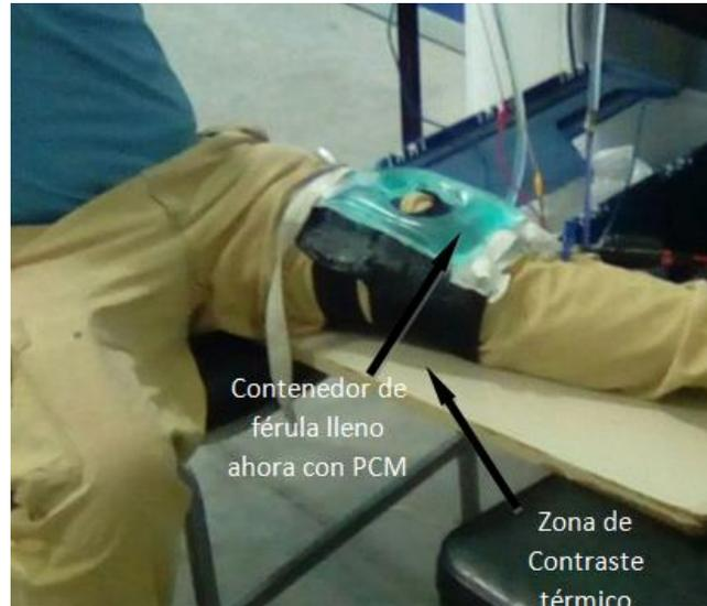
Figura 44 Voluntario usando la férula con el contenedor descubierto lleno de PCM.
