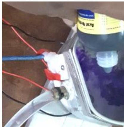
Figura 34 Aplicación de tinte al circuito hidráulico.
