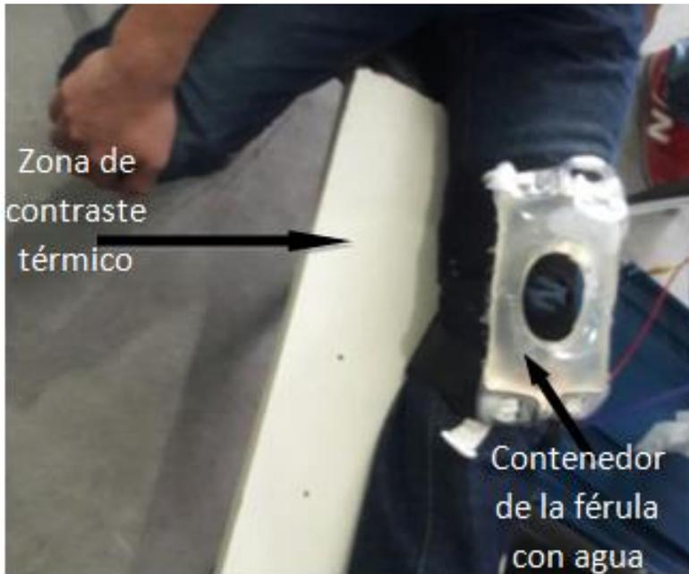
Figura 47 Prueba de la férula usada por un voluntario utilizando agua como fluido.
