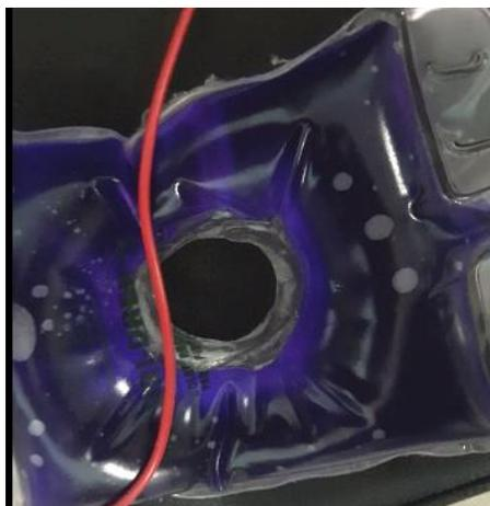
Figura 37 Distribución del tinte debido al flujo 1 minuto y medio después de su aplicación.
