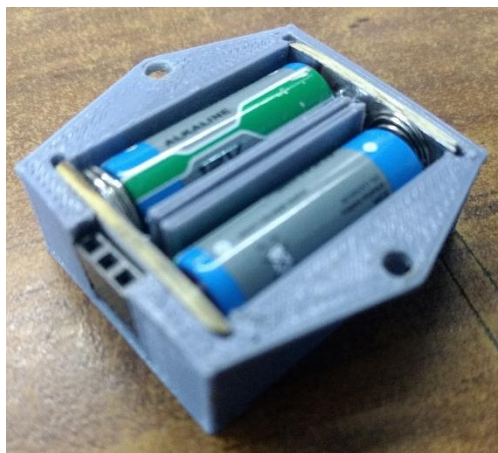
Figura 58 .- Módulo de Baterías
