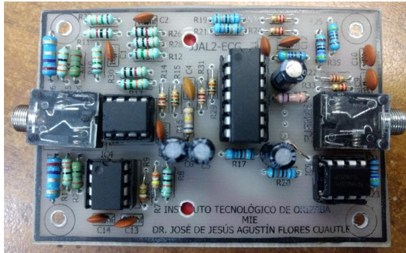
Figura 56 :- Tarjeta final del circuito de ECG
