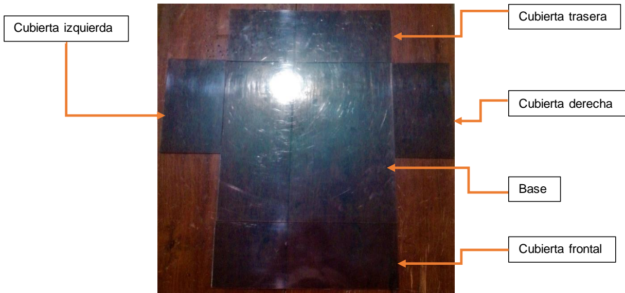
Figura 18 Representación de las seis piezas de mica cortadas para formar el contenedor
