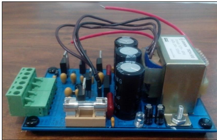
Figura 24 Fuente de alimentación culminada
