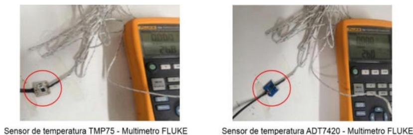
Figura 34. Comparación de sensores de temperatura (TMP75, ADT7420 y Multímetro FLUKE)
