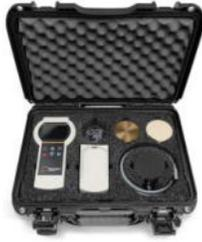
Figura 1. TPS-EFF (Transient Plane Source-EFFusivity) medidor portátil para la obtención directa de la efusividad térmica [1].
