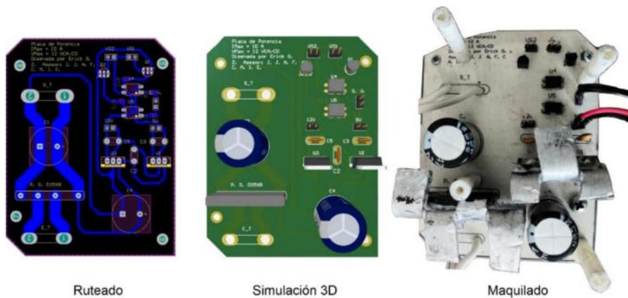
Figura 39. Elaboración de ruteado y maquilado de placa de potencia.
