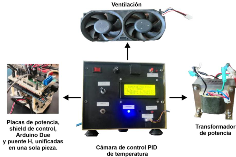
Figura 54. Vistas, acabado y elementos que conforman la cámara de control PID de temperatura.
