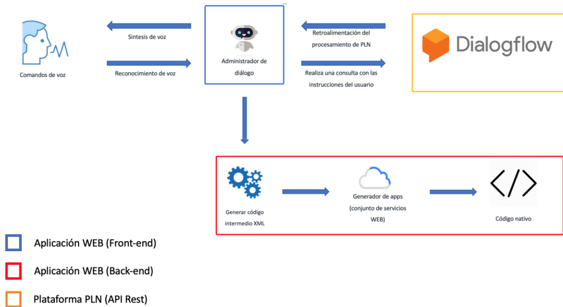
Figura 3.13 Arquitectura del generador de aplicaciones móviles
