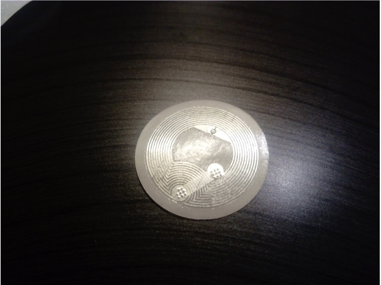
Figura 4. 21 Etiqueta NFC modelo NFC213 con 180 bytes de capacidad.
